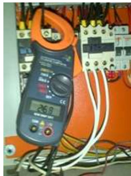
Foto 4. Medida con pinza amperimétrica Elaboración propia
